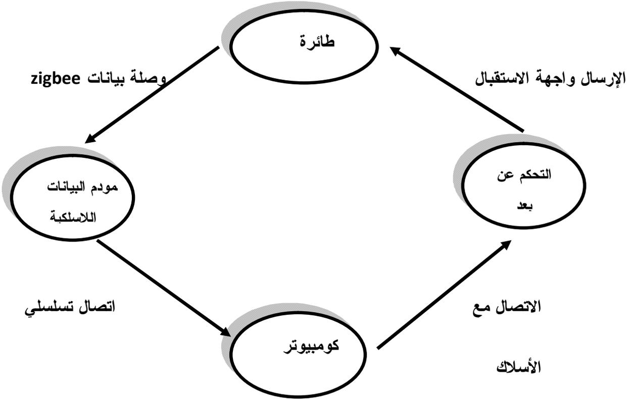
مخطط ( 01 ): يوضح طريقة الاتصال لتشغيل الطائرات بدون طيار.<sup>1</sup>
